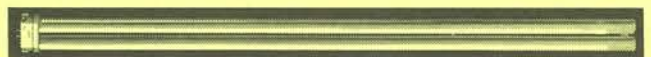
▲96Wツイン1蛍光灯は明るさ8,600lmで長さ860mm、110W直管蛍光灯とほぼ同じ明るさで約1/2のコンパクトさを実現。
